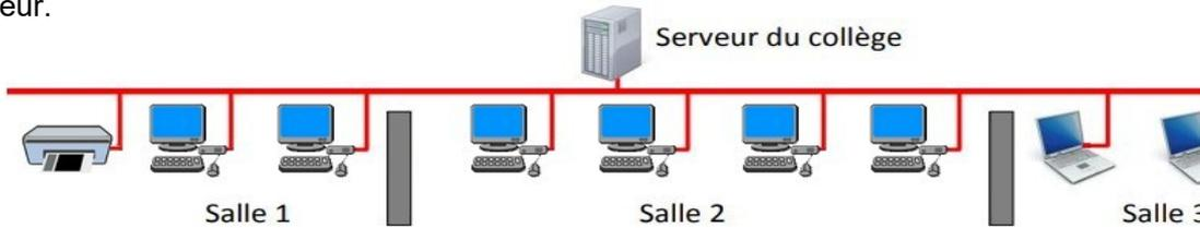
L'ensemble des ordinateurs du collège sont reliés au serveur grâce à des câbles réseaux dissimulés dans les faux plafonds et les baguettes en plastiques fixées sur les murs.
